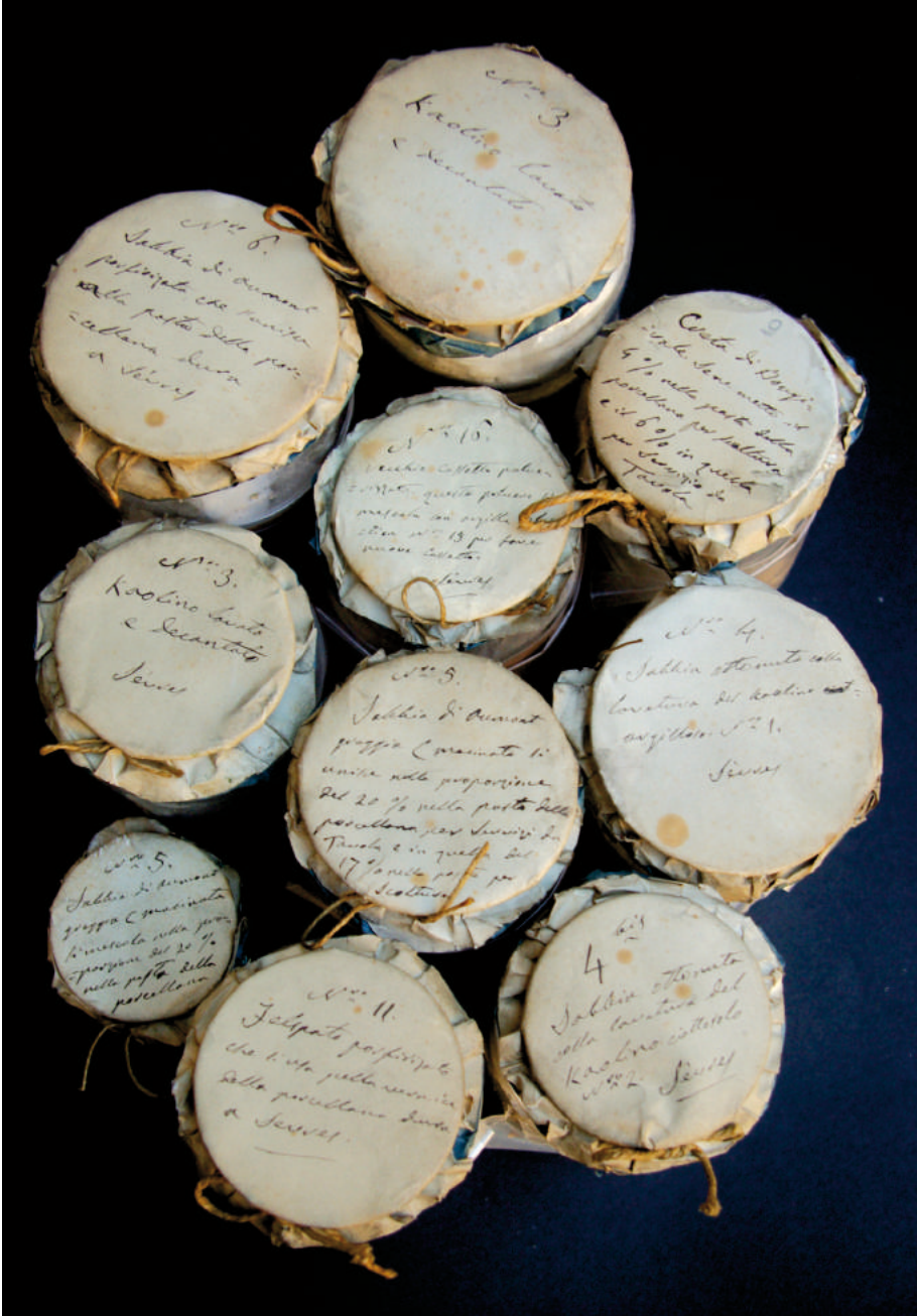
Fig. 6 – Campioni in barattolo di materie prime e semilavorati utilizzati per la fabbricazione della porcellana a Sèvres, inviati da A. Brongniart a A. Sismonda nel 1833 (Museo Mineralogico dell'Università di Torino, collezione M/U17002).
