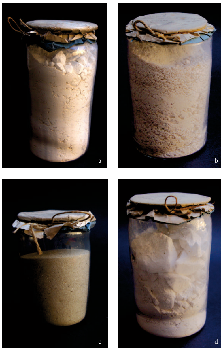
Fig. 7 a-d - Campioni inviati da Brongniart contrassegnati rispettivamente dai numeri: a) «N° 3 Kaolino lavato e decantato», b) «4bis Sabbia ottenuta dalla lavatura del caolino ciottoloso N. 2 Sèvres», c) «N° 5 Sabbia di Aumont greggia macinata si mescola nella proporzione del 20% nella pasta della porcellana», d) «N° 6 Sabbia di Aumont porfirizzata, che s'unisce alla pasta della porcellana dura a Sèvres» (Museo Mineralogico dell'Università di Torino, M/U17002.3, M/U17002.4b, M/U17002.5, M/U17002.6).
