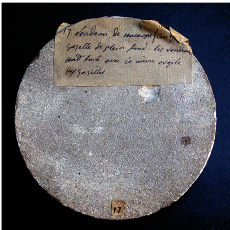
Fig. 5 – Campione inviato da Brongniart etichettato come «17. Rondeau de soucoupe cuit pour gazette de plein fond. Les rondeaux sont faits avec la même argile des gazettes»; si tratta di materiale refrattario per la messa in forno degli oggetti (Museo Mineralogico dell'Università di Torino, M/U17002.17).
